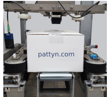
Cintas laterales robustas, accionadas por 2 motores
